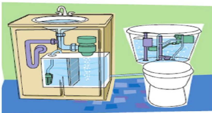
Figure 33: dispositifs de plomberie qui utilisent l'eau grise des éviers pour la chasse d'eau des toilettes
